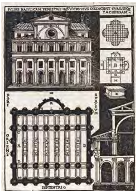
Afb. 8. Façade van de Basilica en doorsnede met de façade van de Pronaos of Voorhal.
