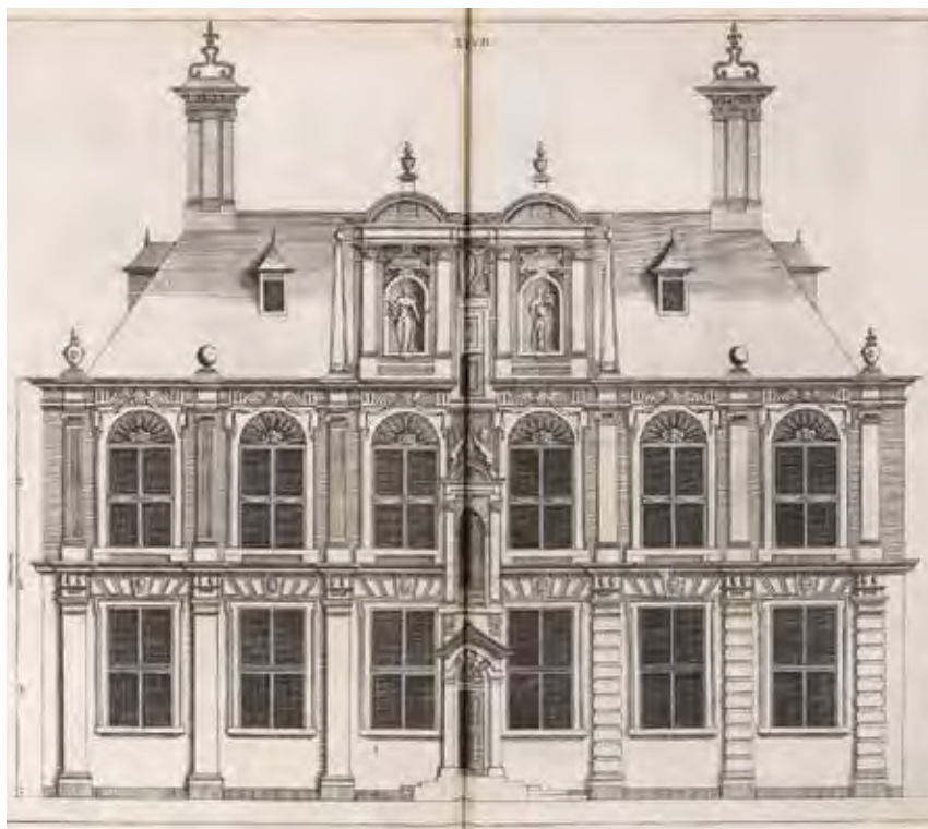
Afb. 2. Hendrick de Keyser, enig en definitief ontwerp voor het Delftse stadhuis, 1618. Spiegelbeeldige gravure uit Architectura Moderna XXVII, 1631. De aangegeven hoogte is 40 voet; de afstand tussen de bartlijnen van de buitenste pilasters 80 voet.
