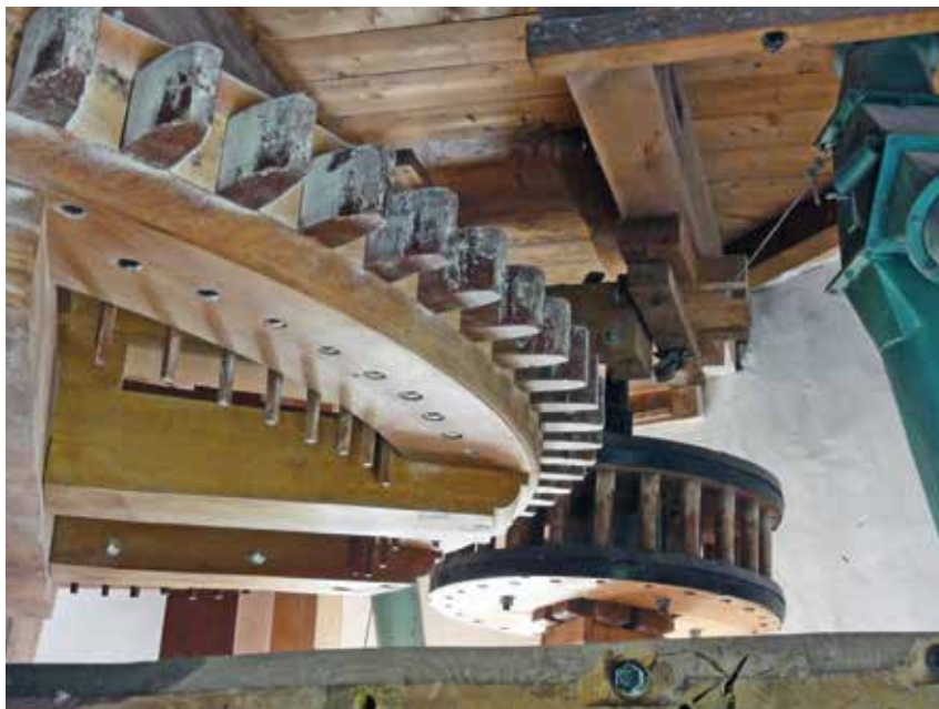
De overbrenging van het spoorwiel met de houten kammen (links), op een schijfloop (rechts).
