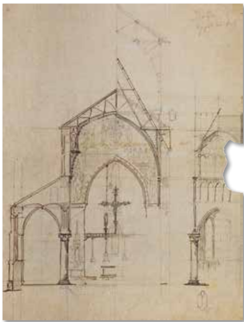
15 Ontwerpschets van P. Cuypers voor een ijzerconstructie boven het middenschip met rechts de later uitgevoerde houtconstructie.
