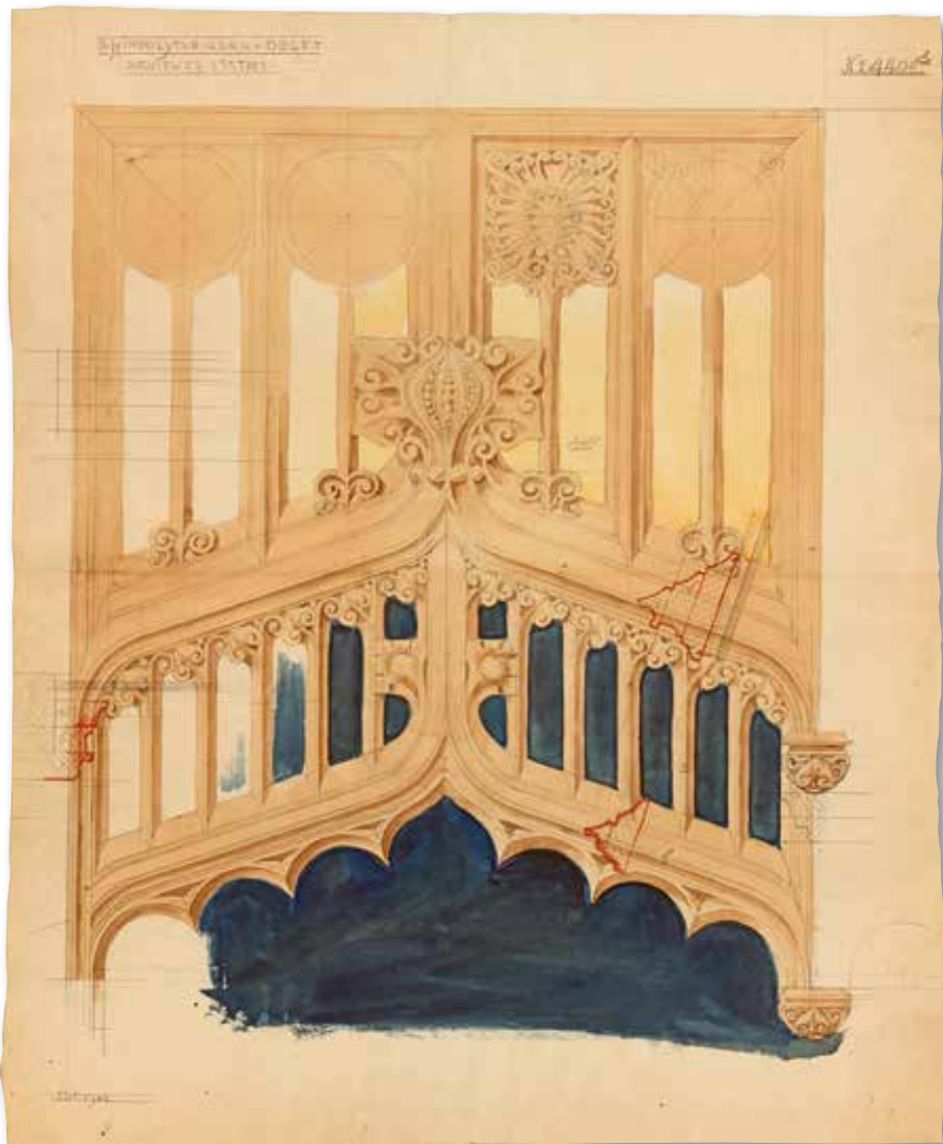
11 Ontwerp van Cuypers uit 1914 voor een lambrisering in de transepten waarin de kruiswegstaties zouden worden opgenomen.
