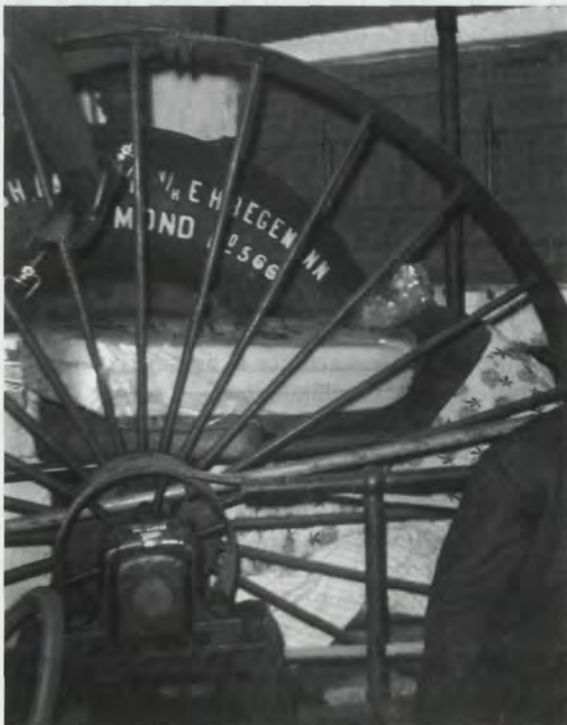
Afb. 3 Het aandrijf wiel in het elektrisch gemaal van de Oudelaanmolen (Foto: J.J. Kaiser).
