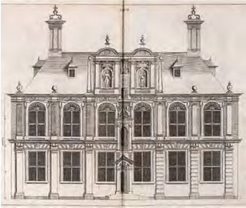
Afb. 2. Hendrick de Keyser, enig en definitief ontwerp voor het Delftse stadhuis, 1618. Spiegelbeeldige gravure, Architectura Moderna XXXVII, 1631. De aangegeven hoogte is 40 voet; de afstand tussen de hartlijnen van de buitenste pilasters 80 voet.
